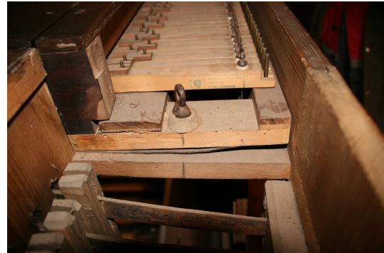
Abbildung 7: Trakturspanner unter dem Spieltischdeckel zur Stabilisierung der Mechanik
