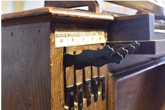
Abbildung 6: Eisenhebel (linksseitig am Spieltisch) zum Ein- und Ausschalten der Register
